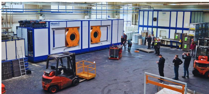
Abbildung 16: Aufbau der Doppelkammerentfettungsanlage
